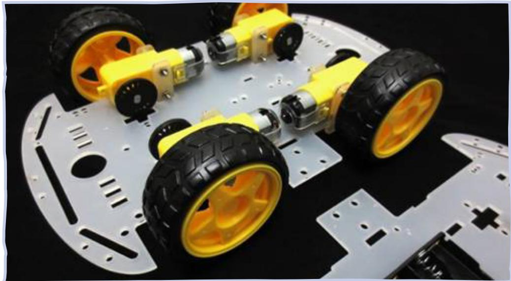
Figura 04: rodas afixadas ao motor. Fonte: <<https://multilogica-shop.com/tutorial/montagem-passo-passo-do-kit-chassi-robotico-4wd>>
