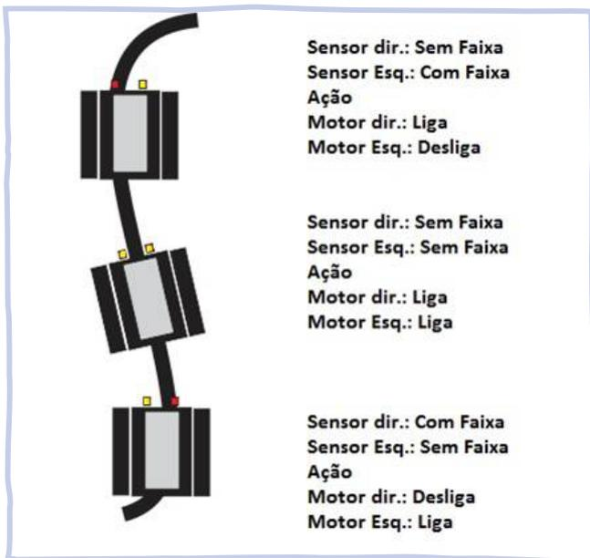
Figura 10: comportamento diante das curvas, em função da leitura do seguidor de linhas. Fonte: internet.
