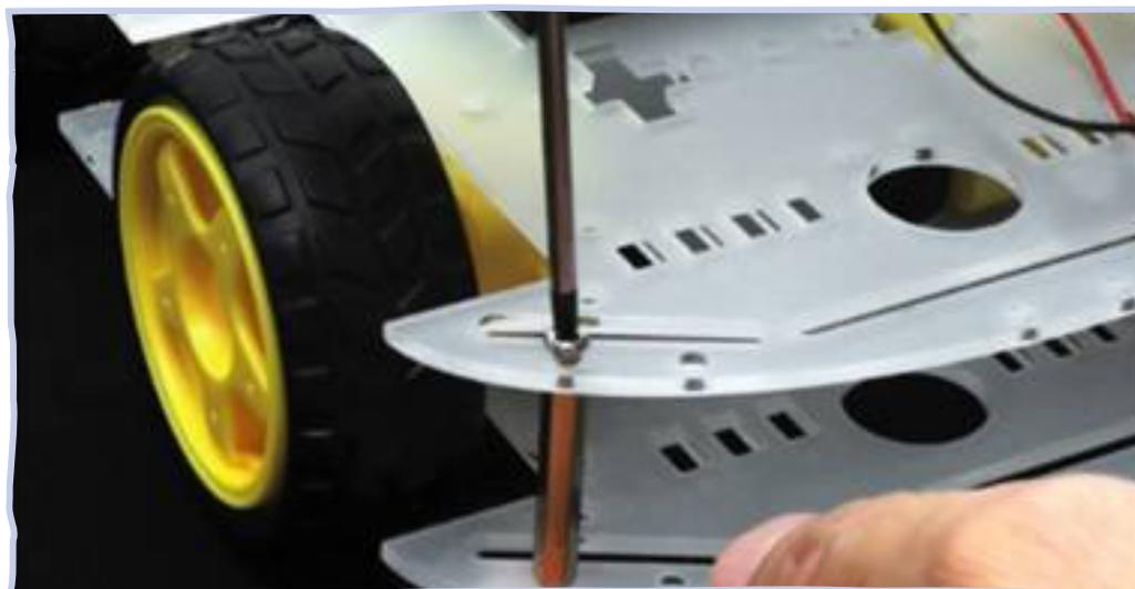
Figura 06: detalhe do espaçador sendo afixado entre as placas superior e inferior. Fonte: <<https://multilogica-shop.com/tutorial/montagem-passo-passo-do-kit-chassi-robotico-4wd>>
